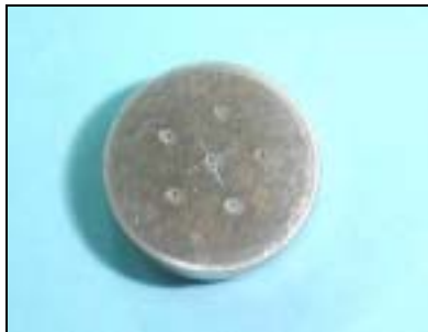
圖一 正極表面平滑，開有氣孔
